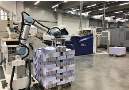
Die Druckerei Geiselberger setzt Cobots an einer Falzanlage ein und verdoppelt so die Produktivität.
