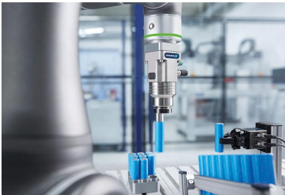
Unter anderem Batteriezellen schnell und zuverlässig greifen: Gerade einmal 200 ms beträgt die Magnetisierungszeit des SCHUNK EMH, hier in der einpoligen Ausführung.
