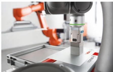
Bauteile werden einfach von oben gegriffen – dabei lässt sich die Greifkraft in vier Stufen einstellen.
