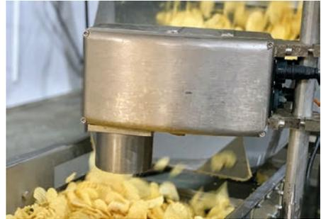
**NIR-Technologie ermöglicht eine berührungslose, wiederholgenaue, drift- und wartungsfreie Messung.**
