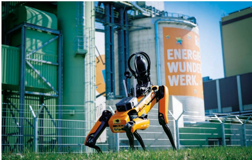
Der Energy Dog von Wien Energie verfügt über zahlreiche Sensoren, darunter eine thermografische Kamera sowie ein Akustik- und ein Schnüffelsensor.
