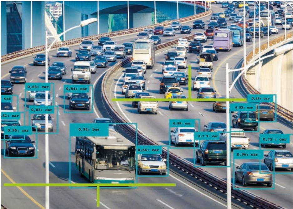
Videostream-Output aus der PLCnext Control mit einem Erweiterungsmodul AXC F ML 1000 zur Klassifizierung und Zählung von Fahrzeugen
