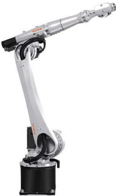
Der KR CYBERTECH HO ist auf Handling-Applikationen spezialisiert, zum Beispiel auf das Sortieren von Brot und das Befüllen von Transportboxen.
