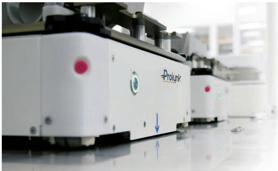
Motion-Controller vom Typ MC 5004 P, Encoder der Serie IE3-1024 und bürstenlose Motoren der Serie BX4 von FAULHABER sorgen dafür, dass die fahrerlosen Transporteinheiten von Prolynk jederzeit die Spur halten.
