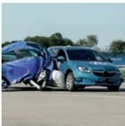
sassen. Der Prototyp eines neuen Pre-Crash-Schutzsystems von ZF kann mit einem externen Seitenairbag Millisekunden vor einer Kollision eine zusätzliche seitliche Knautschzone
